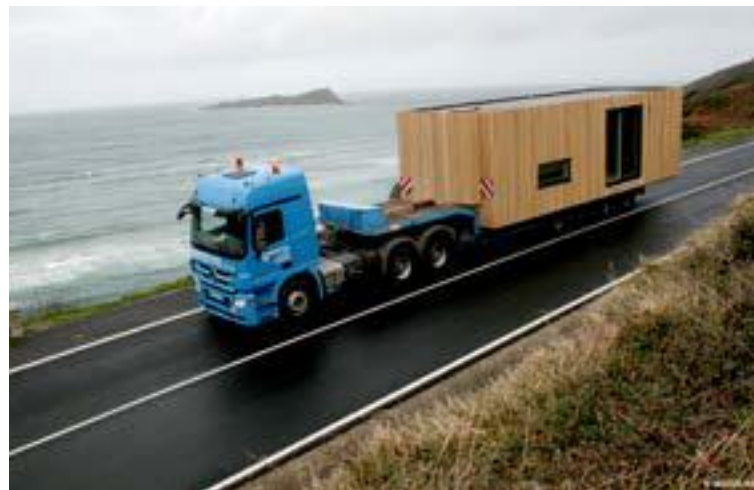
Transporte de módulos de vivienda ecoeficiente.
